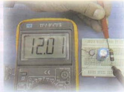
Figura 7.68. Midiendo el voltaje de CC de salida
